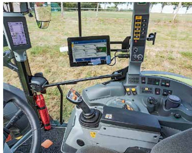
Wielofunkcyjny joystick jest jednocześnie hydrauliczną dźwignią krzyżową. Trzeba się do niego przyzwyczaić.
