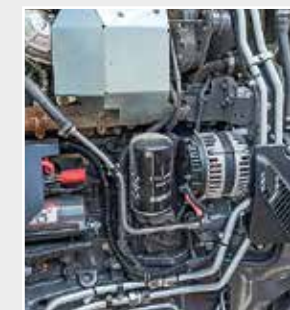
Pionowy filtr oleju to bałagan przy wymianie.
