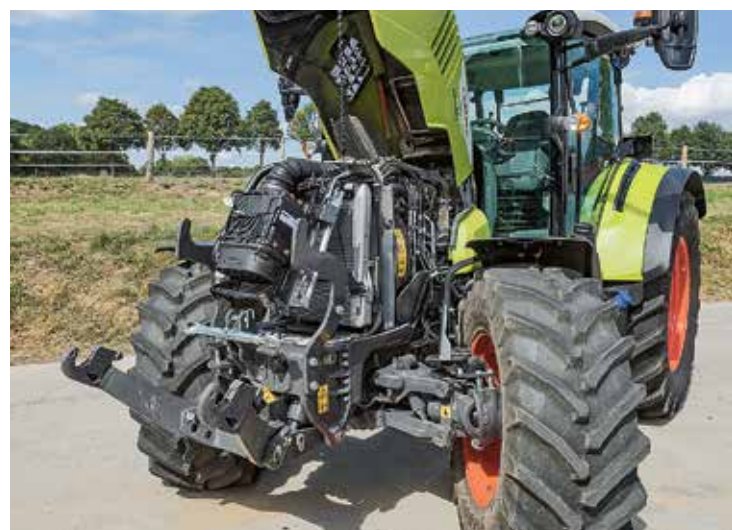
Czterocylindrowy silnik FPT pracuje spokojnie i jest bardzo ekonomiczny. Fot. Tovorinik, Wilmer
