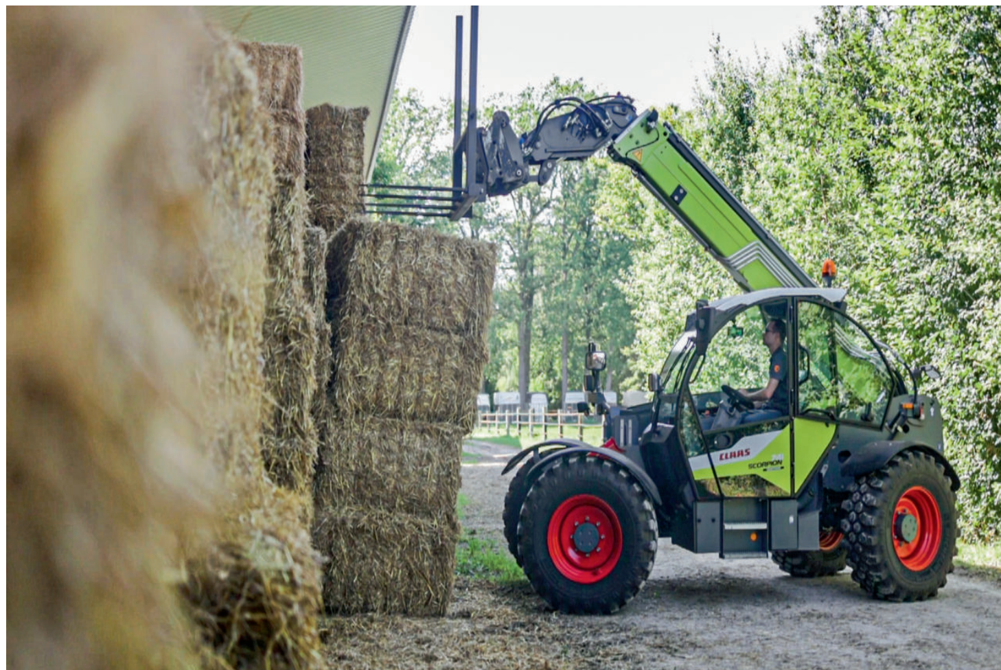
Wenn viel Last hoch hinaus muss, sind Teleskoplader gefragt. Unser Scorpion 741 ist mit 4,1 t Hubkraft und 7 m Hubhöhe der Größte unter den kleinen Scorpionen. Damit passt er gut auf viehhaltende Betriebe. Für den Einsatz auf Biogasanlagen passen die kräftigeren und schwereren Geschwister besser.
