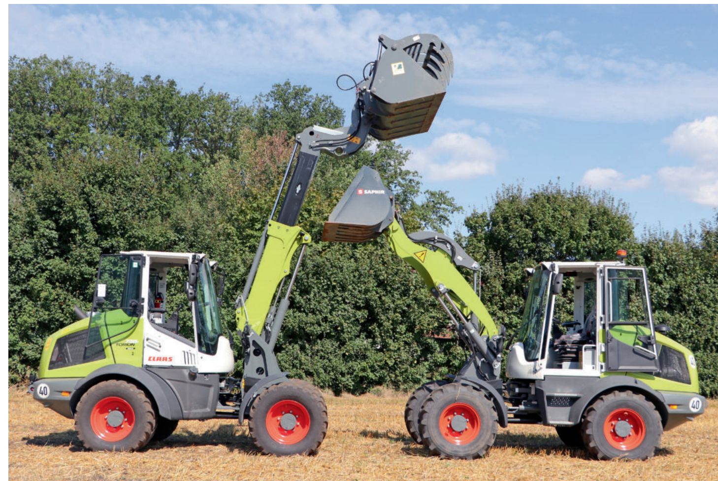
Der Hinterwagen ist gleich. Erst vor der Kabine wird der Radlader Torion zum Teleskopradlader mit dem Zusatz „T“ in der Modellbezeichnung. Der Arm reicht nicht so weit wie bei reinen Teleskopladern. Trotzdem machen die rund 1,80 m mehr Hubhöhe das Beladen von hohen Anhängern einfacher.
