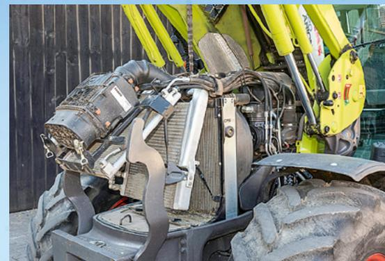
Der 4,5-l-Vierzylinder von FPT hat ordentlich Leistung und einen geringen Verbrauch. Allerdings waren ein Kabel an der Einspritzanlage, ein Abgassensor (heute geändert) und die AdBlue-Füllstandsanzeige im Laufe der gut zwei Jahre defekt. Fotos: Tovornik
