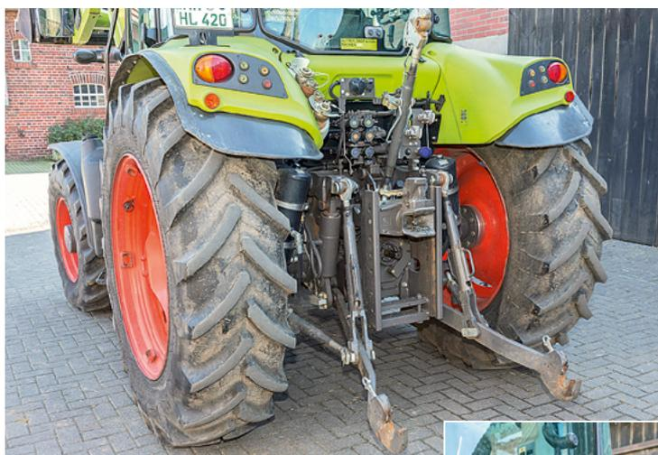
*Hydraulik und Hubwerk sind prima, nur ein undichter Ölanschluss musste ersetzt werden. Die Kotflügelverlängerungen sind ein Eigenbau, genauso der geänderte Oberlenkerhalter (unten). Auch Lecköl-sammler gibt es nur zur Nachrüstung.*
