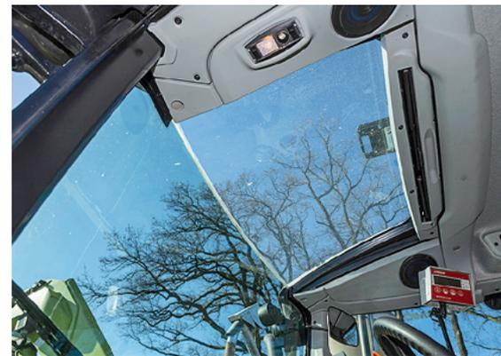
Die Kabine mit Panoramadach überzeugt durch Platz, Komfort und gute Sicht. Die quietschende Lenksäule wurde umgebaut, und die klappernde Sonnenblende hat einen Kantenschutz bekommen (Bild oben).
