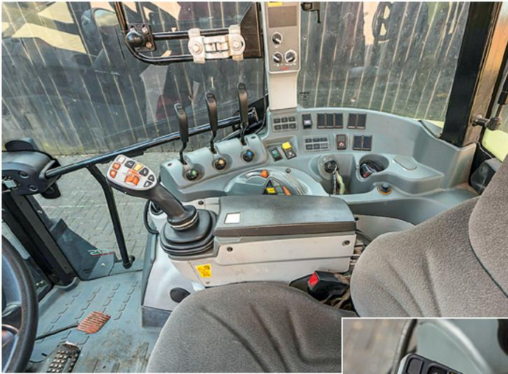
*Vor allem der FlexPilot mit Frontlader- und Hubwerksbedienung sowie Schalung kommt gut an. Nur die F-Tasten sollten besser zu bedienen sein (kleines Bild).*
