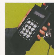
Mit dem Pro- grammiergerät werden die Ansprechzeiten für Kick-Down angepaßt.
