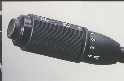
Diese Getriebe machen den RANGER zu einem besonders trak- tionsstarken Lader mit erstaunli- cher Steigleistung. Der Fahrtrichtungshebel befindet sich griffgünstig an der Lenksäule. So kann beim Lastwechsel die
