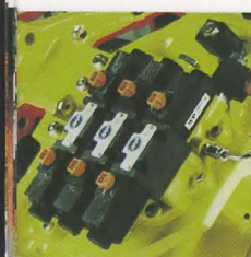
Elektromagnete des Power- Shift-Getriebes übernehmen das Schalten.
