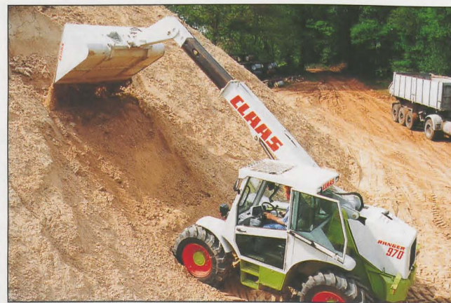
RANGER 970 - PowerShift-Getriebe und hohe Hubleistung bringen Schnelligkeit in jedem Gelände
