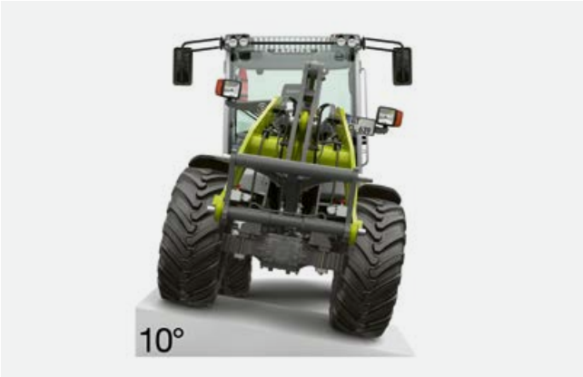
Das robuste Knickpendelgelenk mit einem Pendelwinkel von 10° gleicht Bodenunebenheiten aus und sorgt damit für hohe Standsicherheit und hohen Fahrkomfort.
