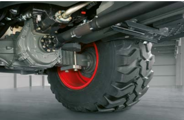
Hydrostatisches Getriebe mit selbsthemmender Bremswirkung
