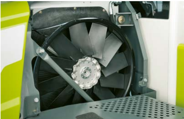
Die Lüfterdrehzahl wird beim TORION (Abb.: TORION 1914 / 1812) kontinuierlich den Gegebenheiten angepasst.
