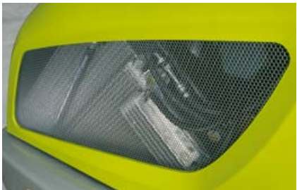
Groß dimensionierte Luftansaugfläche am Kühlerpaket
