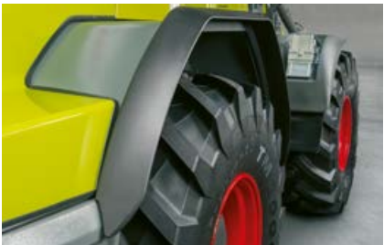
TORION 1511-1177: Radkastenverbreiterung hinten für Bereifung mit 620 mm Breite
