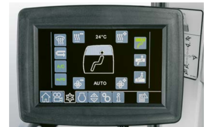
Die Steuerung der Klimaanlage erfolgt wahlweise per Folientastatur oder über das Display mit Touch-Funktion.
