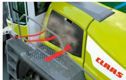
Die Luftansaugflächen und der Kühler sind von Staub und Schmutz befreit
