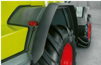
TORION 1511-1177: Radkastenverbreiterung hinten für Bereifung mit 750 mm Breite
