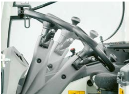
Stufenlos neigungs- verstellbare Lenksäule
