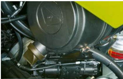
Ein Staubaustragventil entfernt zuverlässig Schmutz aus dem Luftfilter.
