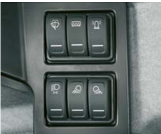
Drei Kippschalter sorgen für ein taghelles Arbeitsumfeld.
