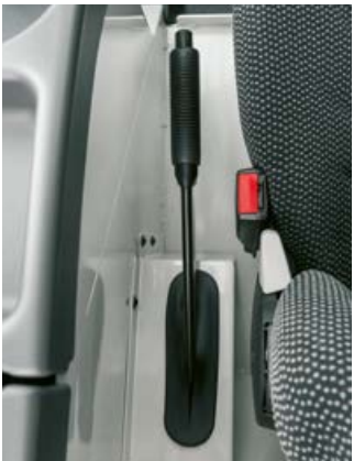
Mechanische Feststellbremse links neben dem Fahrersitz
