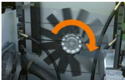
Im Uhrzeigersinn: Luft wird zurückgeblasen
