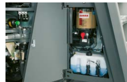
Die Vorratsbehälter für die Zentralschmieranlage und die Scheibenwaschanlage sind im Einstiegsbereich gut sichtbar.
