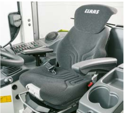
Pneumatisch gefederter, beheizbarer Sitz mit hoher Rückenlehne
