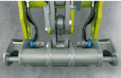
Alles vorbereitet für die geschützte Anbringung von zwei Hydraulikanschlüssen für einen weiteren Steuerkreis
