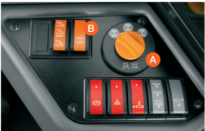
Dreh- Drückschalter (A) zur Auswahl der Lenkart im SCORPION VARIPOWER.
