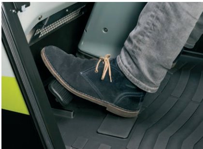
Das Bremspedal mit kombinierter Inchfunktion reduziert Kraftstoffverbrauch und Bremsverschleiß.
