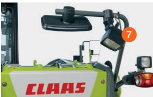
Halogen-Scheinwerfer am Halter des Hecksiegels zur Ausleuchtung des Rückraums.
