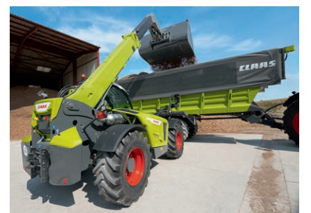
Das Wigesystem ermöglicht ein präzises Befüllen von Transportfahrzeugen.
