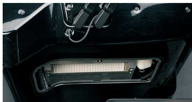
Guter Zugang zum Frischluftfilter für die Kabine.
