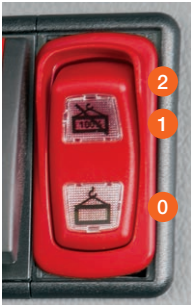
Lastanzeige mit ein-deutiger Ampelsymbo-lik: Ist die Stabilitäts-grenze überschritten, leuchten alle Dioden auf und es ertönt ein Alarmton.
