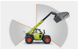
Perfekte Sicht auf das Anbauwerkzeug in allen Positionen
