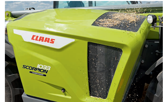
Minimale Kühlerverschmutzung dank Reversierlüfter.
