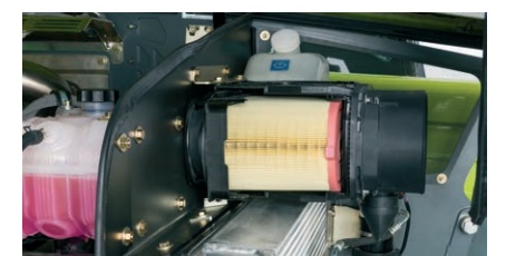
Der Motorluftfilter ist sehr gut zugänglich und kann ohne Werkzeug gewartet werden.
