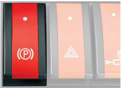
Mit dem Kippschalter kann die Feststellbremse manuell aktiviert werden.
