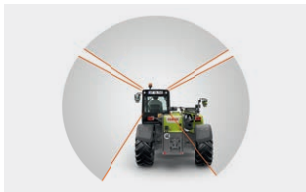
Ungehinderter Blick nach hinten für mehr Arbeitssicherheit, durch tief angelenkten Teleskoparm
