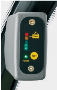
Lastanzeige mit ein-deutiger Ampelsymbo-lik: Ist die Stabilitäts-grenze überschritten, leuchten alle Dioden auf und es ertönt ein Alarmton.
