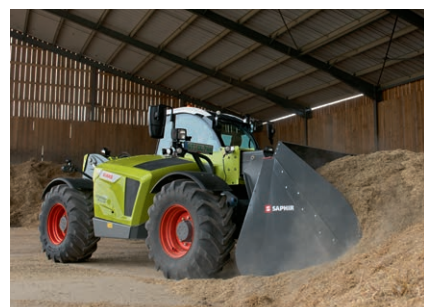
Automatische Schaufelrückführung für schnelleres Arbeiten in Bodennähe.
