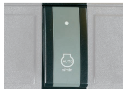
Automatische Schaufelrückführung für schnelleres Arbeiten in Bodennähe.
