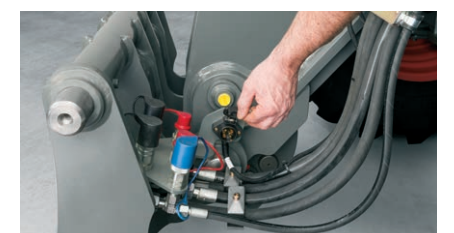
Steckdosen zur flexiblen Stromversorgung verschiedener Anbau- und Anhängegeräte.
