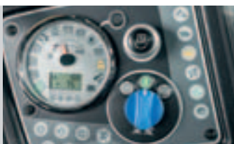
Lenkartenverstellung bequem und sicher über den Dreh-drück-Schalter
