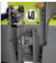
Hydraulikanschlüsse am Heck mit Auffangbehälter und Druckluftbremsanlage
