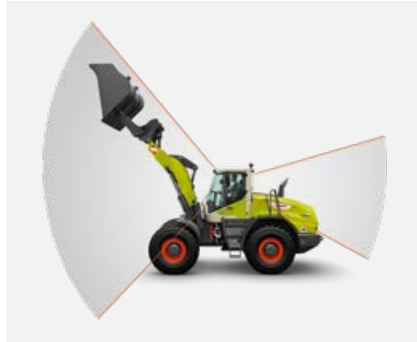
Die schmalen Seitenholme bieten Ihnen freie Sicht auf den Werkzeugträger.
