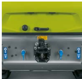
Am Heck befinden sich zwei zusätzliche hydraulische Schnellkuppler.
