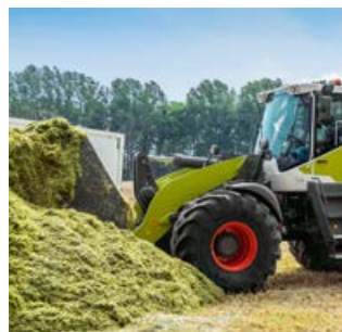
Reduzierte Auskippgeschwindigkeit schützt die Komponenten am Hubgerüst.
