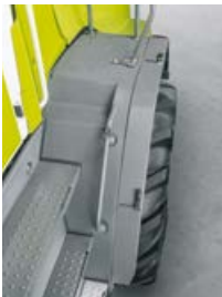
Bei allen TORION der mittleren Baureihe können sämtliche Kotflügel verstellbar bestellt werden, um speziell beim Arbeiten an der Silowand, die Sicht auf die Räder zu verbessern.
