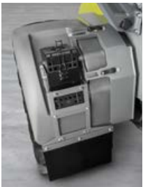
Bei allen TORION der mittleren Baureihe können sämtliche Kotflügel verstellbar bestellt werden, um speziell beim Arbeiten an der Silowand, die Sicht auf die Räder zu verbessern.
