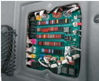
Die Elektronik ist gebündelt und gut zugänglich.
