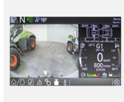
Die Rückfahrkamera schaltet sich automatisch ein, wenn Sie den Rückwärtsgang einlegen.
