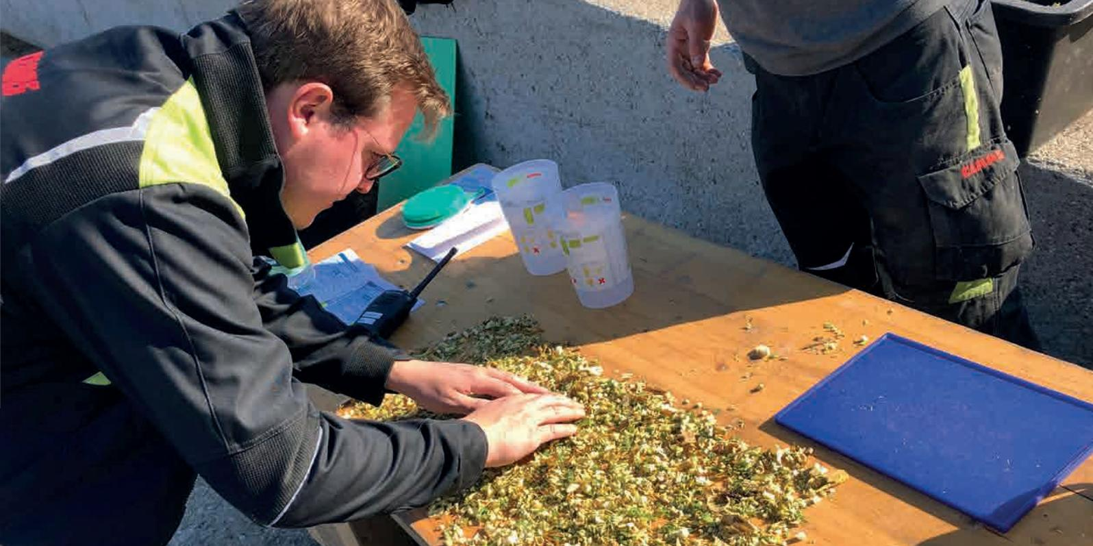
Anhand der Sichtkontrolle wird bei allen Häckselproben die Kornaufbereitung beurteilt.
