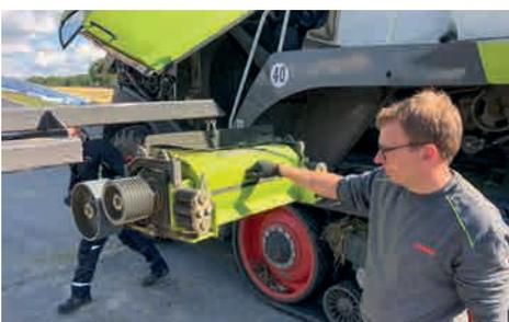
Seitlicher Austausch des kompletten Crackeraggregates beim JAGUAR TERRA TRAC
