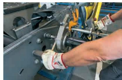
Über die Erfassung von Drehmoment, Drehwinkel sowie mithilfe einer Schraubenkennlinie stoppt der Schraubautomat, sobald die Streckgrenze einer Schraube erreicht ist.
