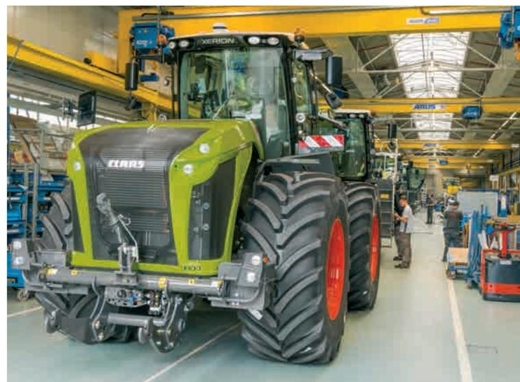
Am Ende der Bahn 4 rollen derzeit jeden Tag zwei fertig montierte XERION aus der Fertigungshalle.
