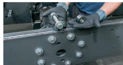
Damit die Schraubverbindung die Seitenwandplatten der Längsträger nicht zusammendrückt, ist in den Hohlräumen zwischen den Platten und auf Höhe der Schraubendurchgänge je eine Stahlbuchse als Abstandhalter platziert.
