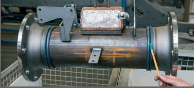
Die Querträgerprofile werden per Reibschweißverfahren mit den seitlichen Verschraubungsflanschen verbunden. Dabei werden die Werkstücke mittels Druck und Reibung erhitzt. So entstehen ebenfalls deutlich stabilere Verbindungen als beim Schmelzschweißverfahren.
