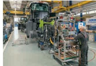
Stationen 8 und 9 jeweils ein Prüfstand. Außerdem muss jeder XERION nach Verlassen der Station 10 eine rund 30-minütige Probefahrt auf einer Teststrecke absolvieren. Erst danach wird er für die Auslieferung freigegeben.
