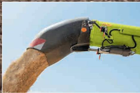
Korntankauslaufrohre mit 330 und 420 mm Durchmesser können jetzt mit einer Schwenktülle ausgestattet werden.
