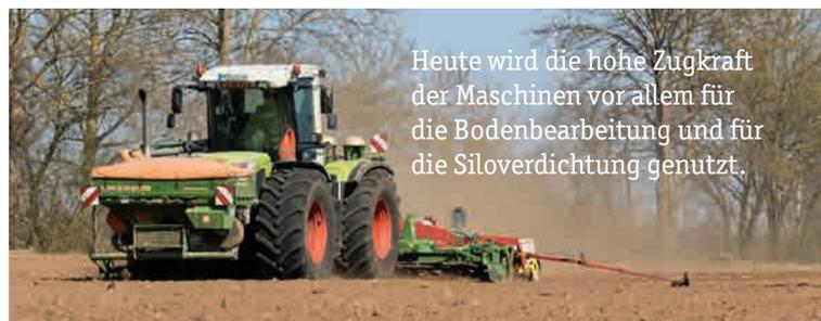
Heute wird die hohe Zugkraft der Maschinen vor allem für die Bodenbearbeitung und für die Siloverdichtung genutzt.
