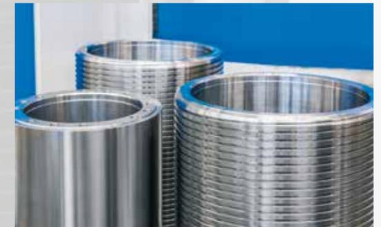
Die Rohlinge der CLAAS Cracker bestehen aus hochwertigem Qualitätsstahl. Auf dem oberen Bild sind am mittleren und rechten Rohling zusätzliche Spiralnuten zu erkennen. Daraus ergibt sich bei der weiteren Verarbeitung das spezielle Zahnprofil der patentierten SHREDLAGE® Walzen.
