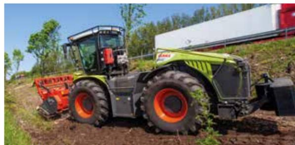
Die drehbare Kabine ermöglicht einen guten Überblick.
