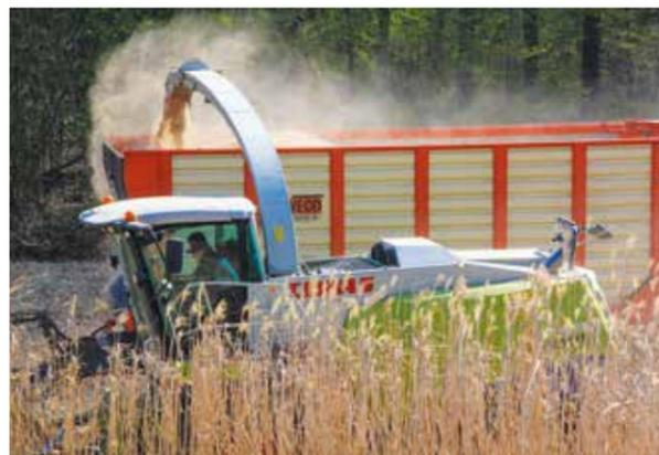
Die Ernte von Miscanthus erfordert Vorsatzgeräte mit großen Einzugscheiben wie das ORBIS und einen gut gewarteten Häcksler. Das harte Material erhöht den Kraftbedarf deutlich und verdoppelt den Verschleiß an der Maschine.
