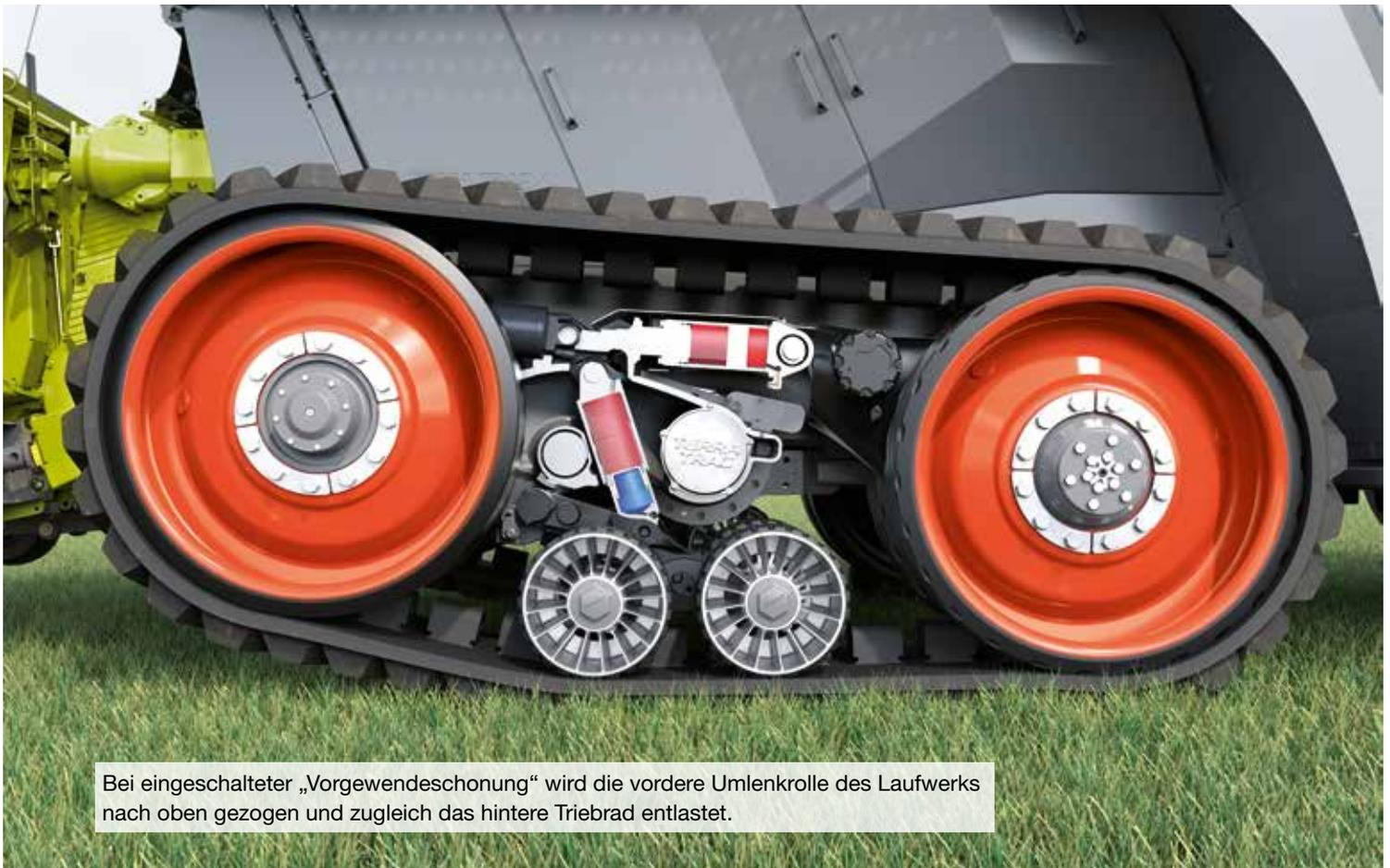
Bei eingeschalteter „Vorgewendeschonung“ wird die vordere Umlenkrolle des Laufwerks nach oben gezogen und zugleich das hintere Triebtrieb entlastet.
