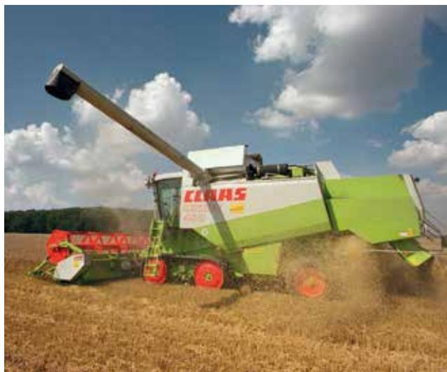
Beim TERRA TRAC Laufwerk der Generation I hatte das Laufwerk noch eine starre Anbindung an die Achse.
