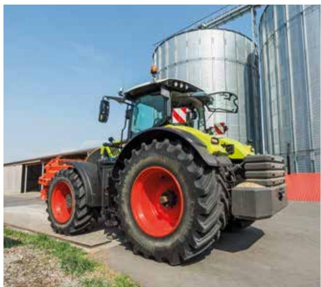
Als leichtester Testkandidat brachte der AXION 950 mit 3 t Zusatzgewicht immerhin noch 18,1 t Gesamtgewicht auf die Waage (36 % auf der Vorder-, 64 % auf der Hinterachse).
