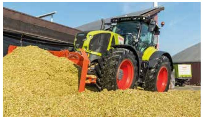
Beim AXION 950 belief sich die Lagerungsdichte auf  $274 \text{ kg TS/m}^3$  – ebenfalls ein sehr guter Wert. Der AXION 950 ist das richtige Walzfahrzeug, wenn der Traktor in der restlichen Zeit des Jahres bei Ackerarbeiten sowie Transportarbeiten ausgelastet werden kann.
