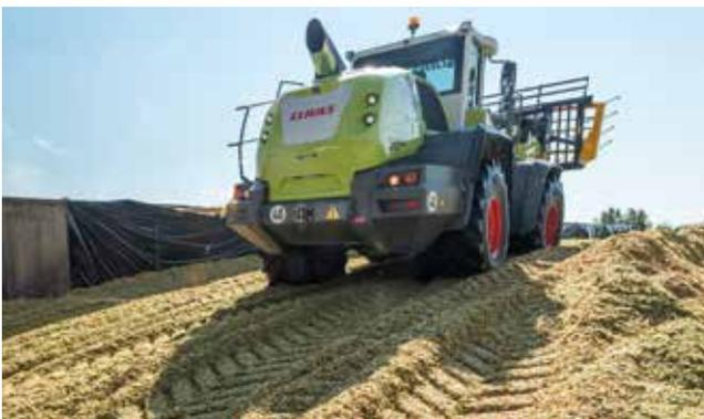
Mit einer Lagerungsdichte von  $271 \text{ kg TS/m}^3$  steht der TORION dem AXION in nichts nach. Neben der Walzleistung eignet sich der TORION als Lademaschine für schwere Schüttgüter und bietet viele Möglichkeiten zur Nutzung verschiedener Vorsatzgeräte. Er bietet ebenfalls eine sehr gute Übersicht auf das Arbeitsgerät.
