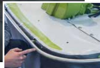
Ein interessantes Detail ist, dass in dem Edelstahlrohr ein-gelegte Drahtseil. Im Falle eines Kompletverlustes des Anfahrschutzbügels zeigt der Feldhäcksler mit seinem Metall-detektor diesen im Erntegut sicher an und große Schäden an den Erntemaschinen werden so vermieden.
