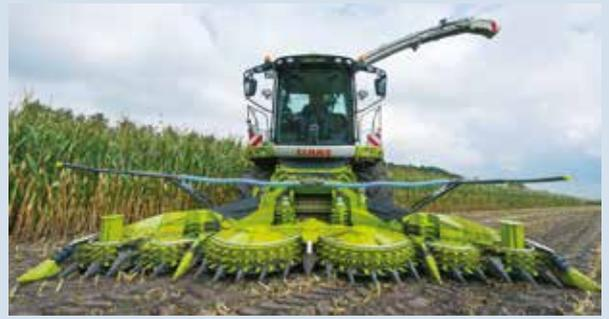
Mit 900 mm Einzugskanalbreite erreichen die beiden ORBIS mehr Durchsatz.
