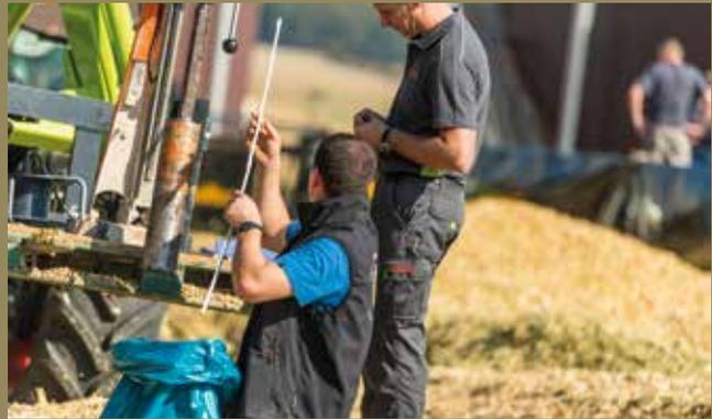
Aus der Verrechnung des Bohrkernvolumens mit dem Gewicht der Probe ergab sich die Dichte der Frischmasse.
