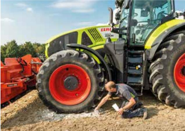
Nicht verschieben: Für die Ermittlung der Reifenaufstandsflächen wurden die Außenkanten der Reifen mit Pulver abgestreut.
