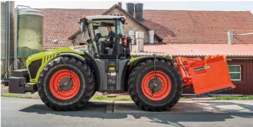
Auf der Waage kam der XERION mit 2,6 t Zusatzgewicht und Schiebeschild auf 22 t Gesamtgewicht, davon 56 % auf der Vorder- und 44 % auf der Hinterachse.
