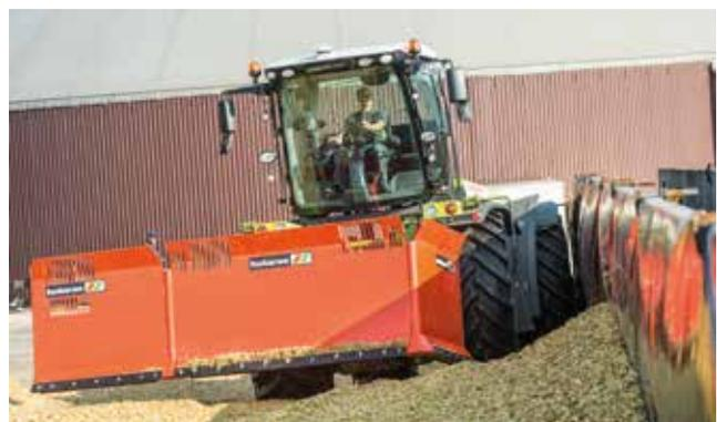
Mit 307 kg TS/m<sup>3</sup> erreichte der XERION den besten Wert für die Verdichtung. Hundegang und Pendelachse des XERION sind speziell für die Kantenverdichtung von großem Vorteil. Außerdem hat der Fahrer bei gedrehter Kabine die beste Sicht auf den Schiebeschild. Der XERION ist für Lohnunternehmen, die sein Schlagkraftpotenzial außerdem für Spezialanwendungen (z. B. Gülleausbringung, Großflächenmähen, Hackschnitzelerzeugung) nutzen können, zu empfehlen.
