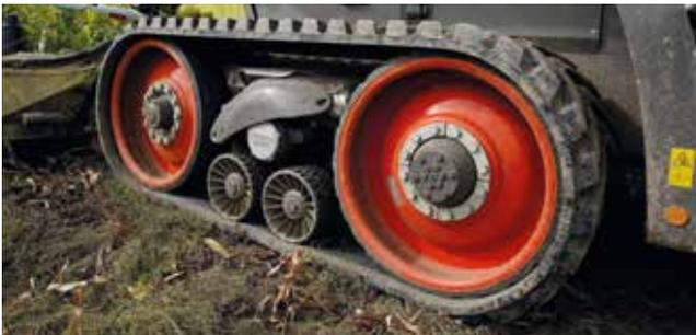
Die Eindringtiefe der Laufbänder ist durch die große Aufstandsfläche i.d.R. deutlich geringer als bei einer Radmaschine.
