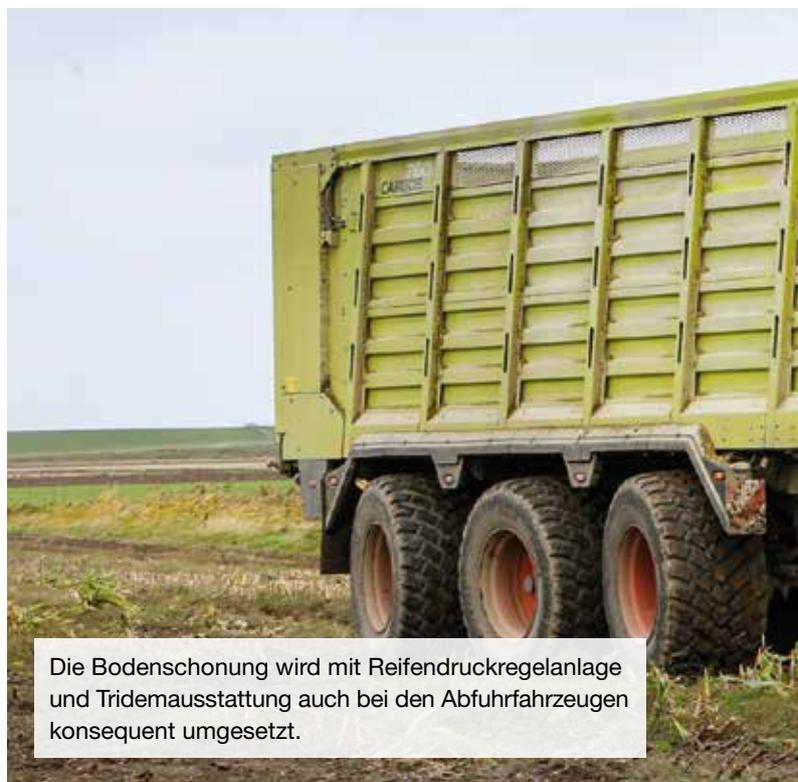
Die Bodenschonung wird mit Reifendruckregelanlage und Tridemausstattung auch bei den Abfuhrfahrzeugen konsequent umgesetzt.
