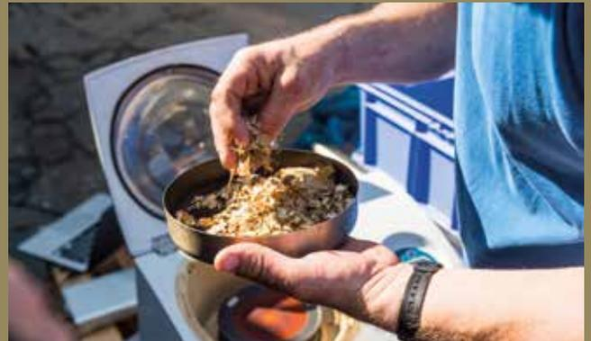
Anschließend erfolgte eine Bestimmung der Trockensubstanz, sodass deren Dichte berechnet werden konnte.
