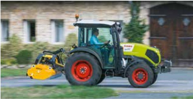
Mit hohem Fahrkomfort durch die Kurve und über die Feldwege ist nun dank passiver Wankstabilisierung durch die neue PROACTIV Vorderachsfederung auch beim NEXOS möglich. Durch die schräg nach außen angestellte Anordnung der beiden Federungszyylinder ist das Traktorgewicht optimal auf der Vorderachse abgestützt. Auch schwere Anbaugeräte werden so sicherer getragen und ein Aufschaukeln des Gespanns vermieden. Die Zylinder sind hinter der Achse verbaut und damit vor Beschädigungen geschützt.
