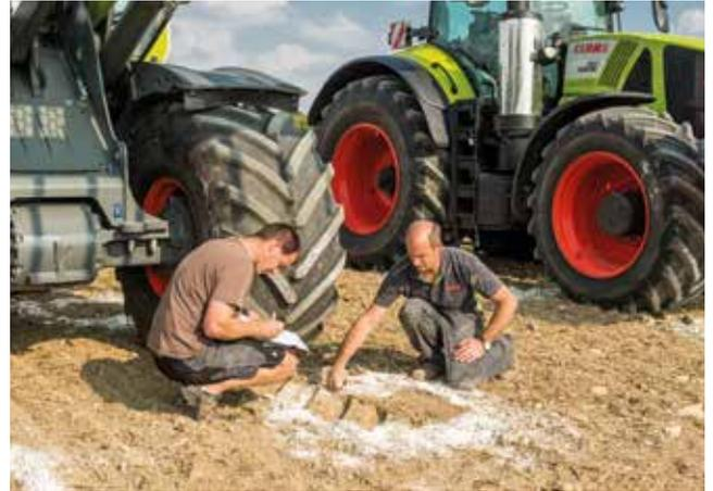
Im zweiten Schritt folgte die Vermessung der Aufstandsflächen.
