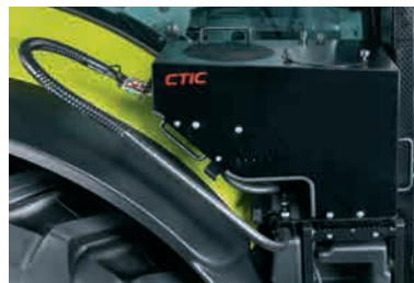
Kompressor der CTIC 2800 kompakt an der rechten Kabinenseite
