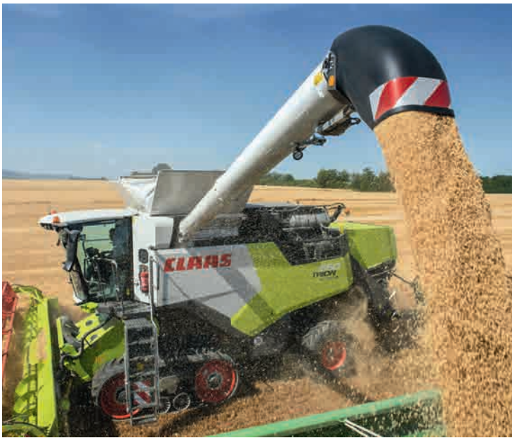
Der Korntank lässt sich mit bis zu 130 l/sec. entleeren.
