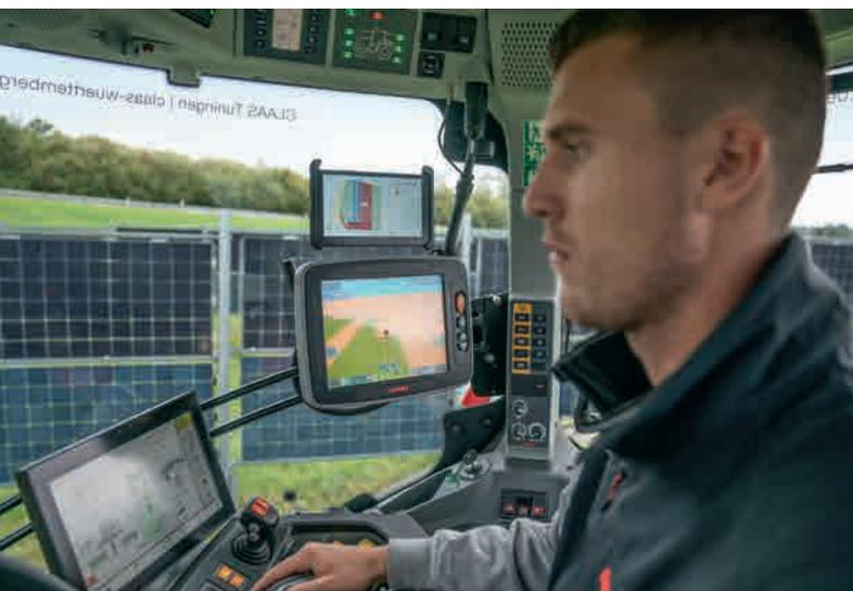
Eine einmalig angelegte und abgespeicherte AB-Linie dient als Referenz, die vom Bordcomputer aus jederzeit auf andere Maschinen übertragen werden kann.
