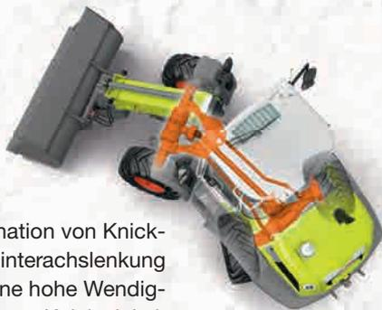
Die Kombination von Knick- und Hinterachslenkung ermöglicht eine hohe Wendigkeit bei geringem Knickwinkel.
