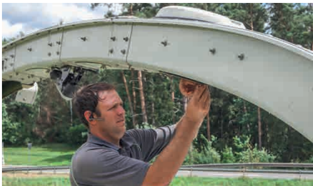
Lohnunternehmer Martin Zintl aus Wiesau kontrolliert den NIRS-Sensor während der Ernte am JAGUAR.
