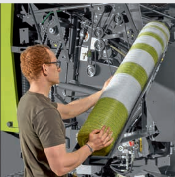
Die Netzzrollenrutsche vereinfacht den Rollentausch.
