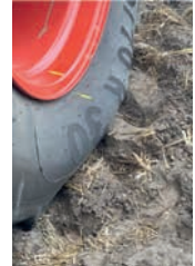
Zu geringer Reifendruck kann u. a. zu Schäden an der Reifenflanke führen.
