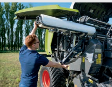
Zum Einlegen der Mantelfolie ist eine verstärkte Variante der Netzzrutsche notwendig.
