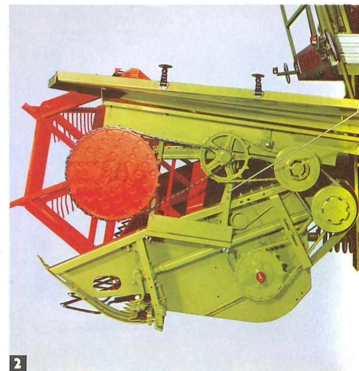
Die Form ist nicht Selbstzweck. Alle Verkleidungen sind schnell hochzuklappen. So bleiben z. B. Hauptantrieb **1** Haspel- und Messerantrieb **2** leicht zugänglich.
