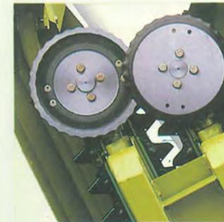
Störungsfreier, tiefer Schnitt – die vorgespannten, selbstschärfenden Mäh-scheiben schneiden und transportieren die Stengel zu den Einzugschnecken.
