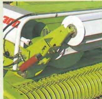
Beim Reversieren wird der Niederhalter hydraulisch hochgeschwenkt. Das Erntegut kann dann zügig zurückgeführt werden.
