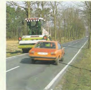
Schnelligkeit ist Trumpf: Pickup ausheben, Tasträder abziehen (3-m-Pickup) – und schon geht's vom Feld auf die Straße zum nächsten Einsatz.
