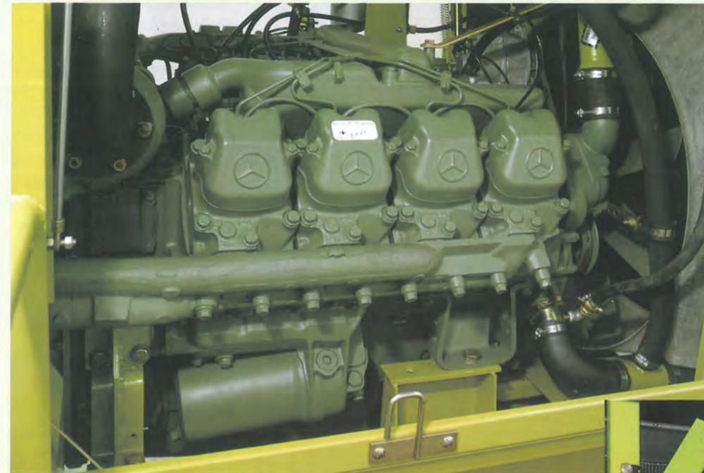
Bei ansteigenden Temperaturen verändert sich das spezifische Gewicht des Kraftstoffs. Die Folge ist eine Verminderung des Wirkungsgrades des Motors. Im Dauerbetrieb des Feldhäckslers wird der Kraftstoff aufgeheizt, weil ca. 70% der von der Einspritzpumpe geförderten Menge in den Rücklauf gehen und nur 30% verbrannt werden. Hier schafft der Kraftstoffkühler Abhilfe. Er stabilisiert die Kraftstofftemperatur auf ca. 10° C
