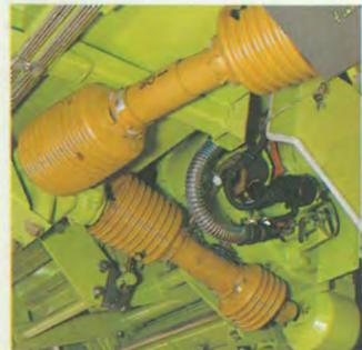
Starke, robuste Antriebe sichern störungsfreien Dauereinsatz. Da sind Gelenkwellen ideale Kraftüberträger. Überlastsicherungen schützen die Funktionselemente vor Schäden.
