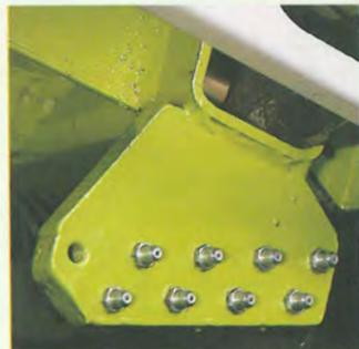
Wartungsarbeiten sind schnell und leicht durchgeführt. Wo immer möglich werden Schmiernippel zu Gruppen zusammengefaßt.
