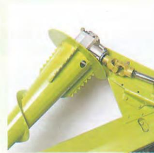
Angetriebene Lagermaisschnecke (Schutzvorrichtungen abgenommen).
