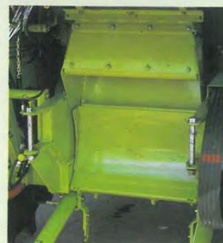
Für die Ernte von Anwelkgrassilage wird der Corn-Cracker durch einen Grasschacht ersetzt.
