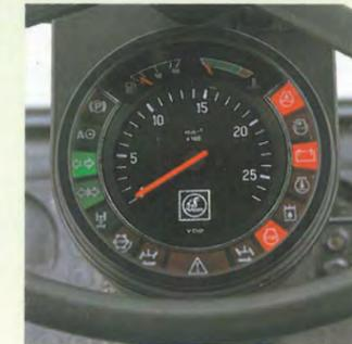
Der Fahrinformator – direkt unter dem Lenkrad im Blickfeld des Fahrers – informiert, wie der Name schon sagt, über alle Fahrfunktionen. Also zum Beispiel über die Fahrgeschwindigkeit, die Motortemperatur, den richtigen Motoröldruck, die Batterieladung, den Kraftstoffvorrat und vieles andere mehr.
