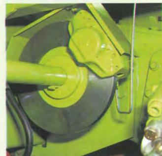
Scheibenbremsen – selbstverständlich mit asbestfreiem Belag – geben dem Fahrer Sicherheit in jeder Situation.
