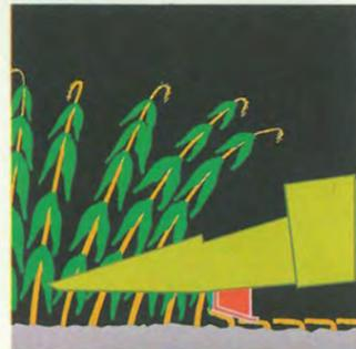
Dicke verholzte Maisstoppeln sind ganz schön hart. Sie können einen Reifen auf Dauer strapazieren. Eine ganz einfache Einrichtung – der Stoppelknicker – legt die Stoppeln um und verhindert Reifenschäden.
