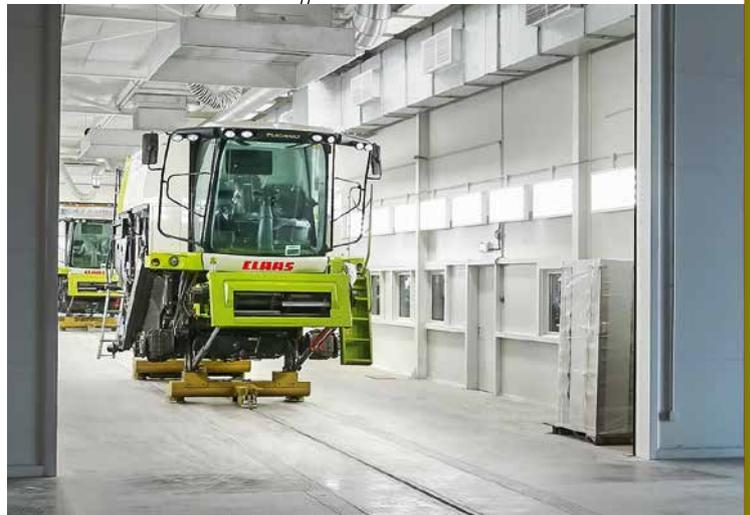
Z Die letzten Meter in der Fertigung: Öffnet sich das Tor, wird der fertig montierte Mähdrescher zur Endkontrolle buchstäblich ins Prüfzentrum gepustet. Die tonnenschweren Maschinen und Bauteile werden mit einem Luftdruck von sechs bis sieben Bar auf Schienen durch die Fabrik bewegt.
