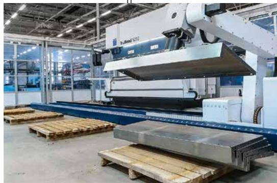
**3** Vollautomatisch biegt dieser Roboter Bleche mit millimetergenauer Präzision. Dadurch nimmt er den Arbeitern das mühsame Hantieren mit den schweren Bauteilen ab.
