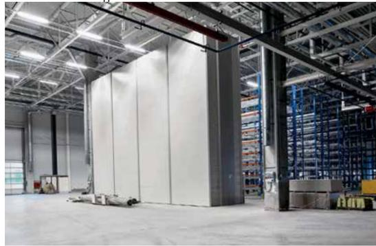
4 Dieses hochmoderne Hochregallager für Kleinteile wird von Computern gesteuert. Im Inneren befinden sich bewegliche Regalböden, die nach dem Paternoster-Prinzip funktionieren. Die Arbeiter tippen die Seriennummer des gewünschten Bauteils ein und eine Software befördert das gewünschte Bauteil innerhalb weniger Sekunden zum Ausgabefenster.
