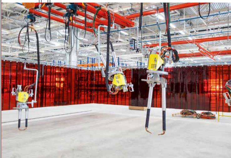
**1** Der Anfang der Montagelinie – hier werden die Karossen der Fahrzeuge verschweißt. Für diese technologisch anspruchsvollen Arbeiten wurden die Schweißer über mehrere Monate in Krasnodar und Harsewinkel ausgebildet.
