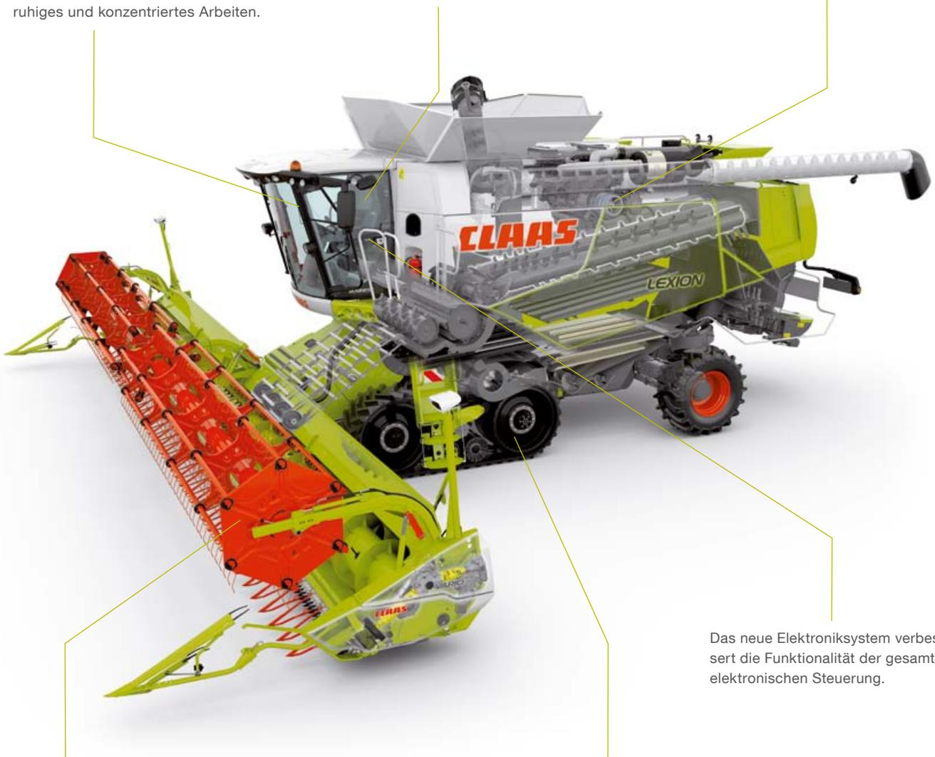
VARIO Schneidwerk mit bis zu 12m Breite sorgt für bis zu 10% mehr Leistung durch optimierten Gutfluss.
