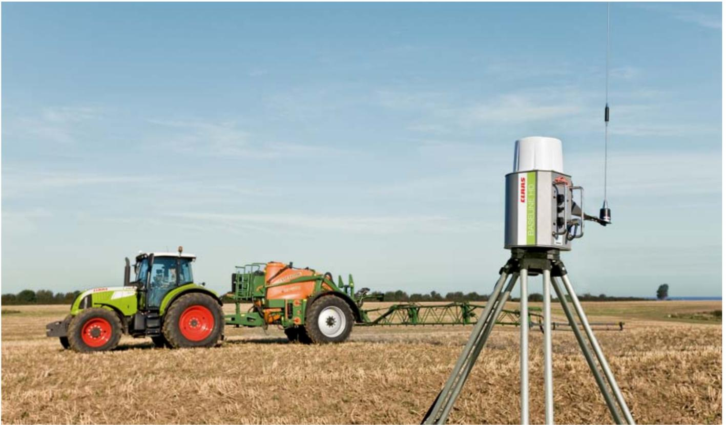
On field: Der Sender im Vordergrund verfeinert das GPS-Signal. So bleibt der Traktor immer hoch präzise in der Spur.
