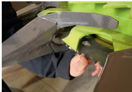
Die neuen Sägezahnmesser arbeiten bis zur Verschleißgrenze optimal.
