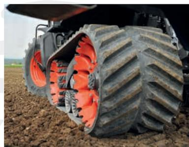
Weil Antriebsrad, Umlenkrad und die Zwischenrollen einzeln gefedert sind, kann sich das TERRA TRAC Laufwerk sehr gut dem Boden anpassen.
