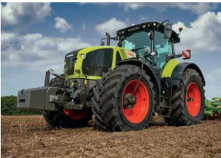
Besteht ein Schadverdichtungsrisiko, kann der Fahrer z. B. den Reifendruck ändern und die Auswirkungen dieser Gegenmaßnahme direkt mit Terranimo® überprüfen.
