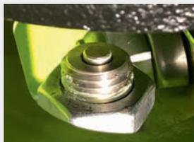
Durch diese sinnvolle Schraube, die den federbelasteten Stift in sich trägt, wird erheblich Zeit bei der Schleifsteineinstellung gespart. Aufwändiges Ausmessen und Justieren werden vermieden, und der Stein wird beim Festziehen auch nicht beschädigt.
