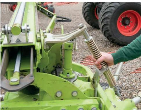
Die Aufhängung der einzelnen Kreisel mit je einer Doppelfeder sorgen für einen schnellen Ausgleich der einzelnen Kreisel.
