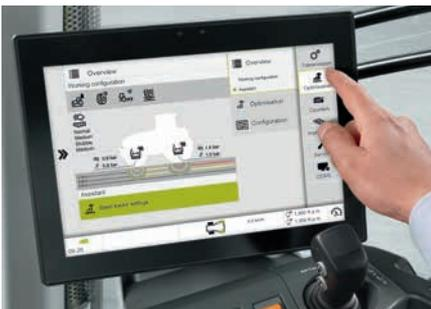
Auf dem Traktorterminal erkennt der Fahrer anhand farbiger markierter Bodendruckzwiebeln, ob das Risiko für Schadverdichtungen groß, mittel oder gering ist.
