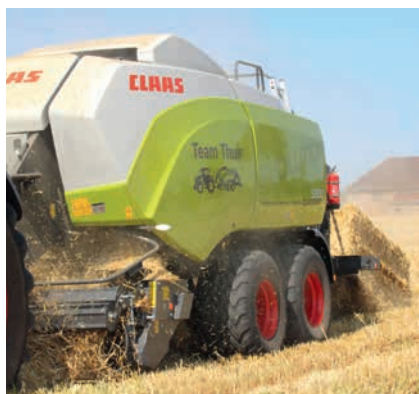
Im Praxiseinsatz zeigt sich, dass auch die 5-reihige, beidseitig kurvenbahngesteuerte Pickup noch ruhiger läuft.
