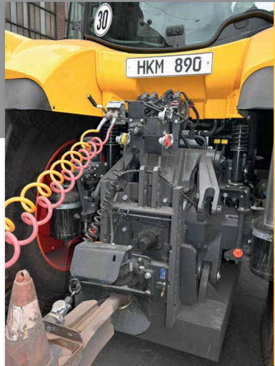
Ein größeres Zugmaul war eine der Spezifikationen, die an dem Schlepper vorgenommen werden mussten.
