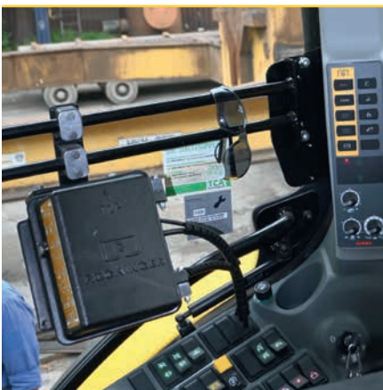
Um den Fahrern das kraftraubende Lösen der Bolzen zu ersparen, ist in der Schlepperkabine eine Fernentriegelung installiert worden.
