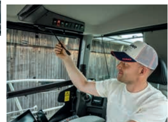
Weiterentwickeltes Schwanenhals-Mikro für besonders gute Sprachübertragung
