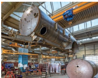
Sämtliche Schneide- und Schweißarbeiten wie auch die Endmontage erfolgen im Werk der Reesink Production B.V.
