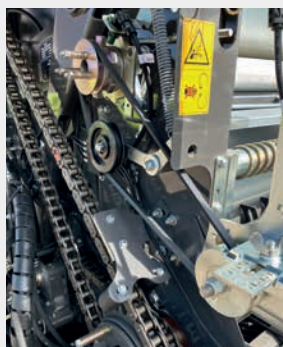
Einlauf- und Antriebsrolle sind unmittelbar mit einem Keilriemen miteinander verbunden.
