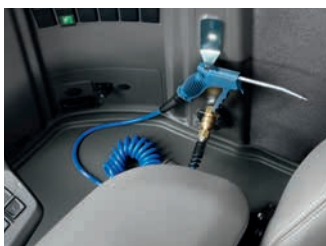
Luftdruckanschluss und -pistole für die Innenreinigung der Kabine
