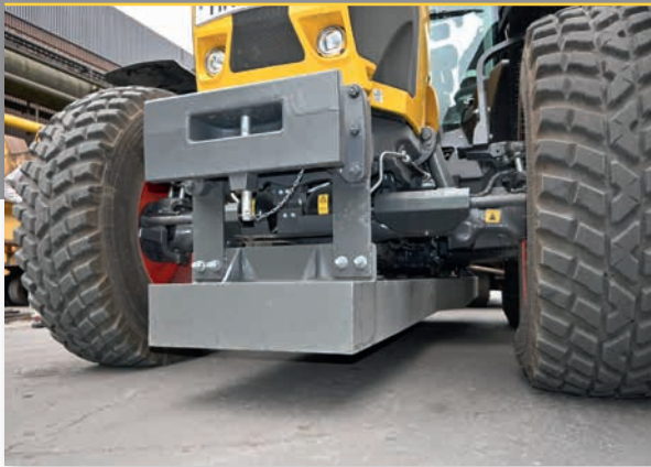
Ein Stahlblock wurde als Sondergewicht unter dem Schlepper verschraubt.
