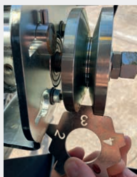
Mithilfe einer Lehre lassen sich 5 verschiedene Vorstreckungen einstellen. In Stufe 3 sind es 5 % Vorstreckung.
