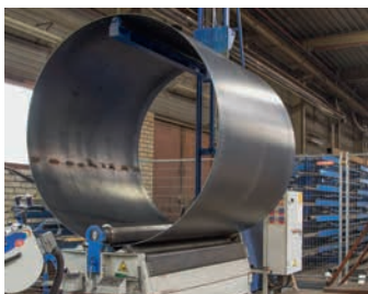
Eine Biegemaschine formt aus Stahlplatten Hohlzylinder in der Größe des späteren Fassdurchmessers.
