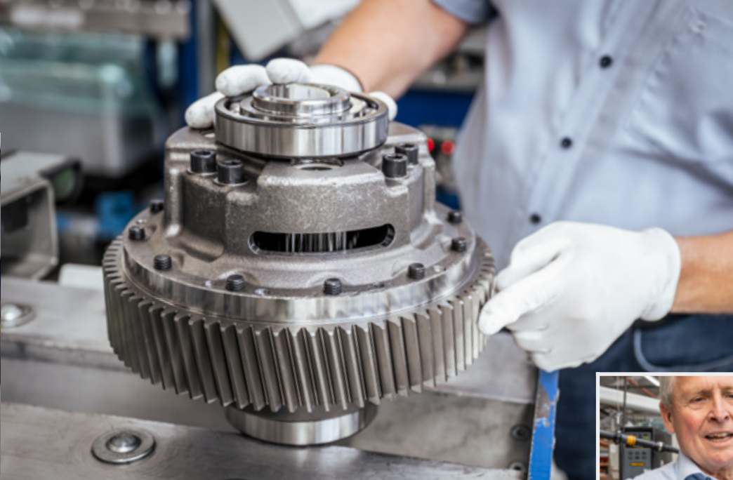
↑ Das Stufenplanetengetriebe, hier fertig montiert, sorgt dafür, dass mechanische und hydrostatische Leistung je nach Fahrbereich unterschiedlich miteinander kombiniert werden können. Seine besondere Bauweise ermöglicht außerdem den automatischen Wechsel zwischen den beiden Fahrbereichen.
