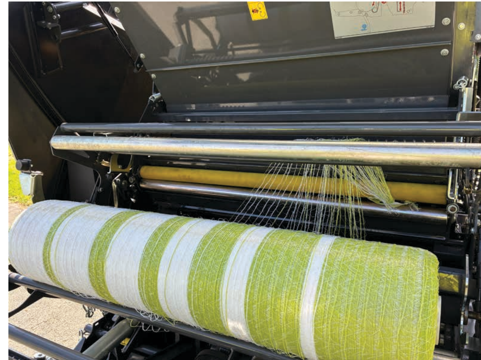
2 Netz am Rand der Bindung zwischen Gummi- und Andrückwalzen durchführen
