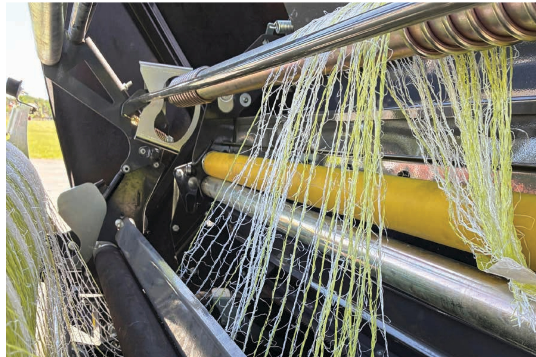
1 Netz unter der Bremsrolle und über der Spiralwalze durchführen
