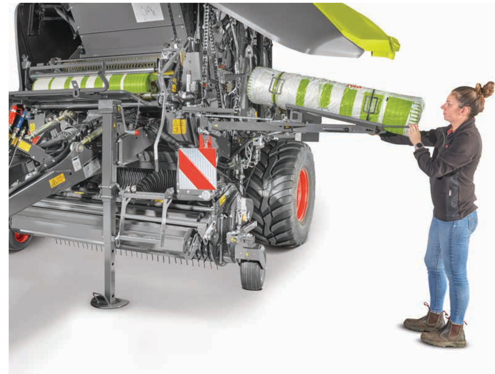
Netzrampe wird zur Bindung bewegt
