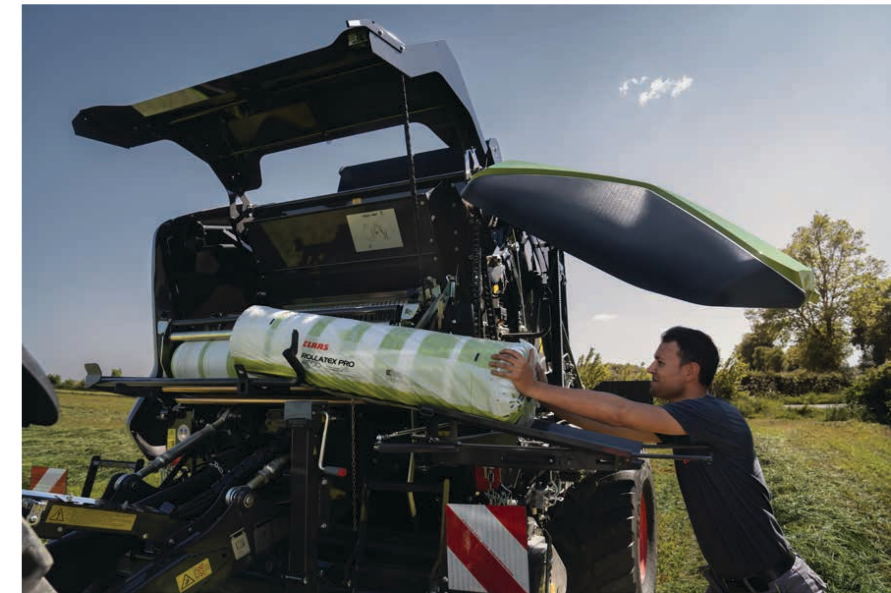
Netz wird vor die Bindung geschoben
