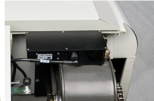
Sensor im Körnerelevator
