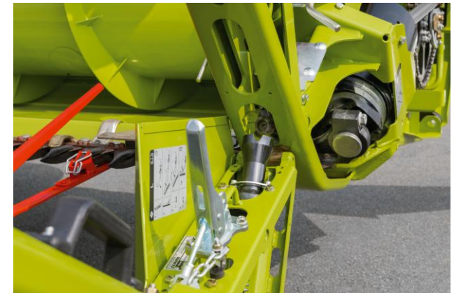
Beim Hochklappen wird der Antrieb gekoppelt.
