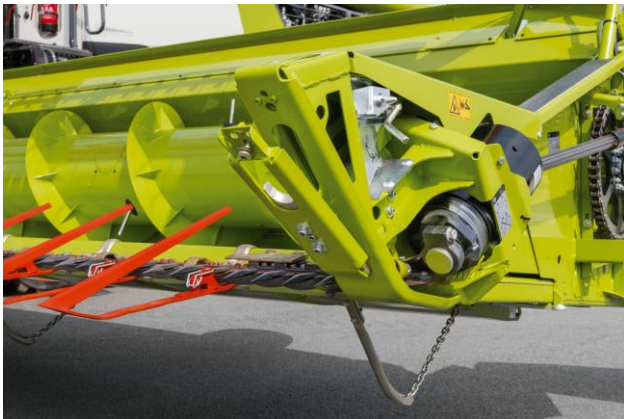
Halmteiler abnehmen und Einstellplatte über Camlock abnehmen.
