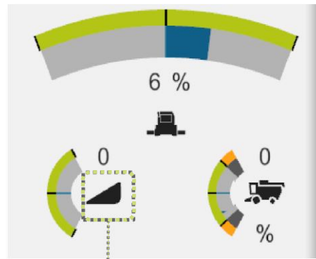
Feldfahrt mit leichter Querneigung und ohne Längsneigung
