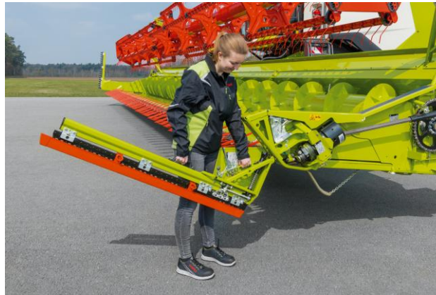
Trennmesser in die untere Aufnahme einhängen.
