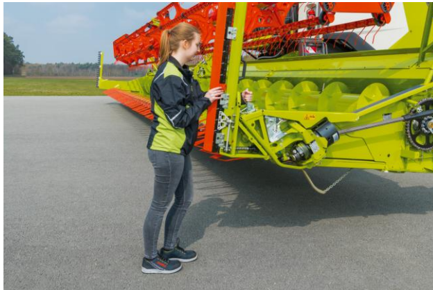
Schnellverschluss einhaken und vorspannen.
