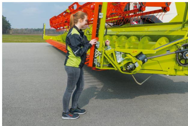
Schnellverschluss einhaken und vorspannen.
