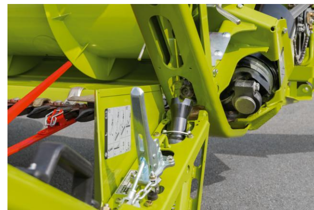
Beim Hochklappen wird der Antrieb gekoppelt.
