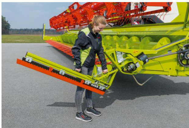
Trennmesser in die untere Aufnahme einhängen.
