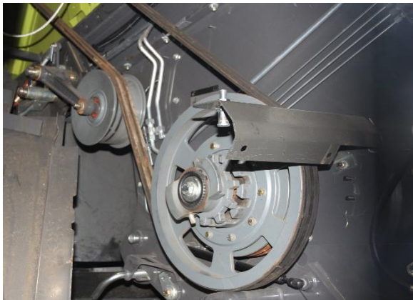
Manuelles Ein- und Auskuppeln des Häckslers über Klauenkupplung
