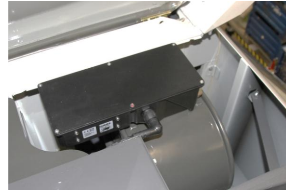
Sensor im Körnerelevator
