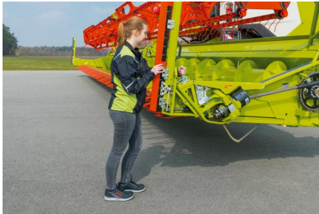
Schnellverschluss einhaken und vorspannen.
