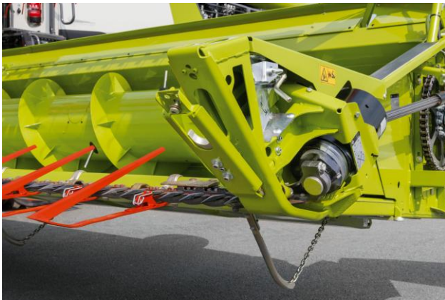
Halmteiler abnehmen und Einstellplatte über Camlock abnehmen.
