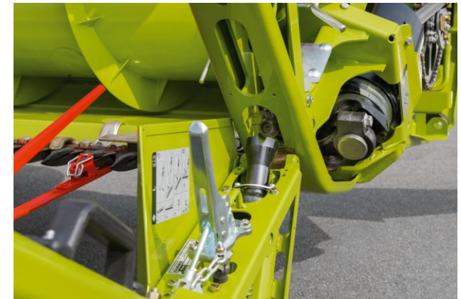
Beim Hochklappen wird der Antrieb gekoppelt.
