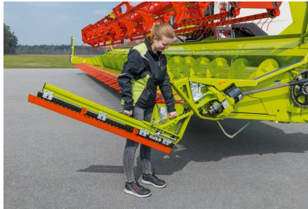
Trennmesser in die untere Aufnahme einhängen.
