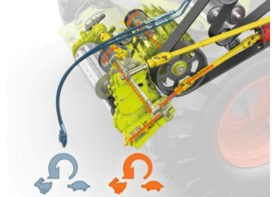
hydraulisch / mechanisch mit zwei unabhängigen und variablen Vorsatzgeräteantrieben
