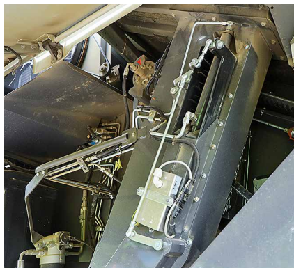
Im Elevator des Evion sind Ertrags- und Feuchtemessung untergebracht.
