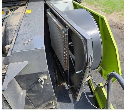
Der Kühler samt Trommelsieb lässt sich zum Reinigen schön aufklappen.
