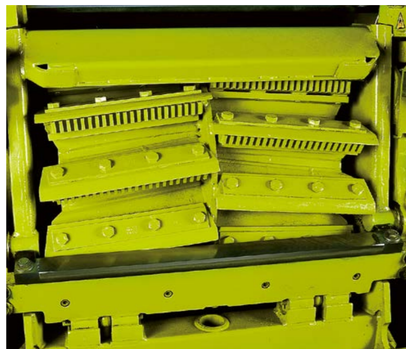
Mikroschlagleisten unter den Messern für zusätzliche Erntegutaufbereitung
