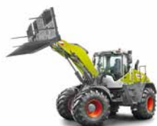
TORION 1611P ca. 15 t Einsatzgewicht ca. 9 t Kippplast voll eingeknickt
