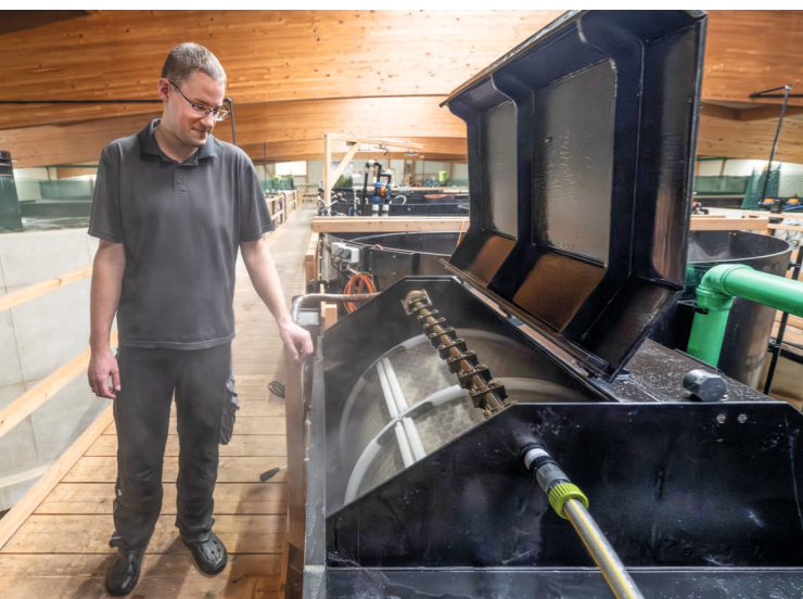
Eine integrierte Wasseraufbereitung sorgt dafür, dass nahezu kein Wasseraustausch stattfindet. „Hier arbeiten wir mit dem Biofloc-System, einer besonderen Form der biologischen Wasseraufbereitung“, erklärt Sven Damm.
