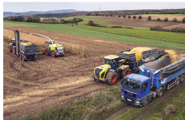
Dank eines Fassungsvermögens von 85 m 3 sind die Überlader so groß, dass sie 25 t frisch gehäckselten Silomais aufnehmen können.
