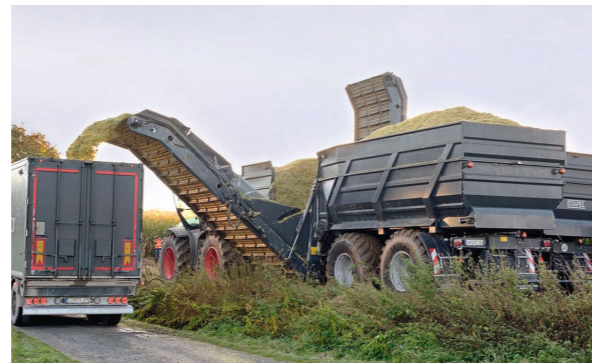
Mit 7 m ist das Überladeband lang genug, um beim Überladen auch einen kleinen Graben überbrücken zu können.
