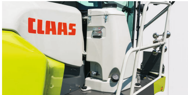
Neben einem Exaktdosiergerät mit 375-Liter-Tank gibt es optional den ACTISILER 37. Er ist rechts neben der Kabine positioniert und fasst 37 l.
