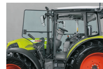
Nach vorne öffnende und dort feststellbare Türen erleichtern den Ein- und Ausstieg aus der Kabine.
