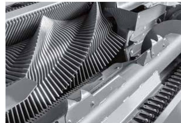
▼ Čistenie uzľovača TURBO FAN
