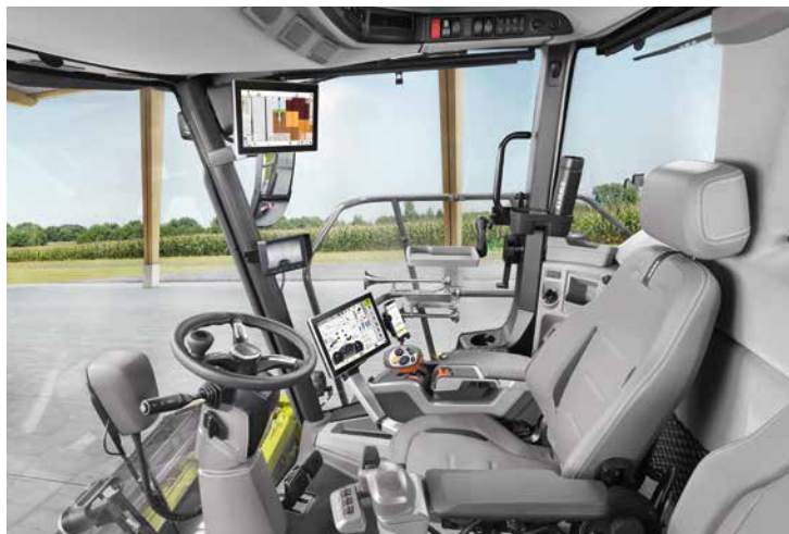
▲ Gran confort, bajo nivel de ruidos, visibilidad panorámica: en la espaciosa cabina montada sobre silent blocks, el trabajo transcurre agradablemente incluso en las largas jornadas de recogida.
