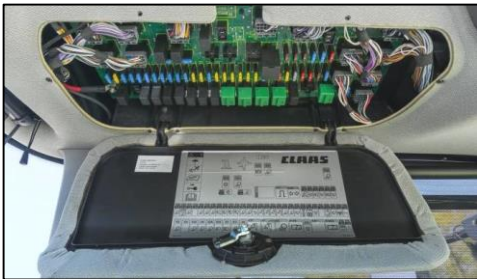
Ein Sicherungstester ist in der jeweiligen ZE vorhanden.
