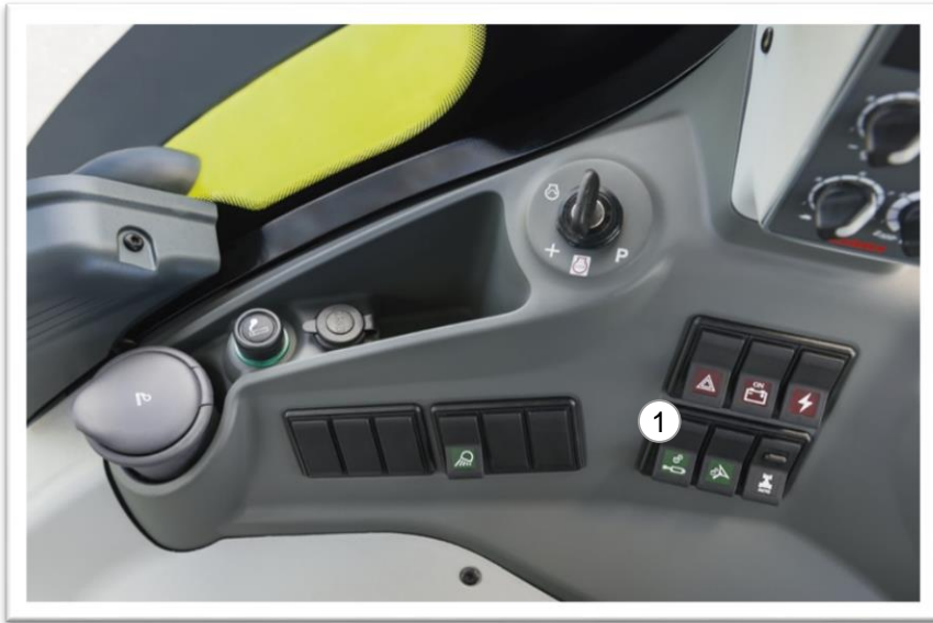
1 – Sperre / Freigabe der Steuergeräte
