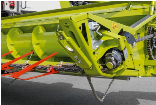
Halmteiler abnehmen und Einstellplatte über Camlock abnehmen.
