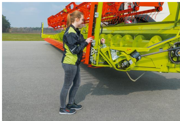
Schnellverschluss einhaken und vorspannen.
