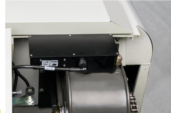
Sensor im Körnerelevator
