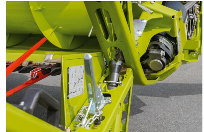
Beim Hochklappen wird der Antrieb gekoppelt.
