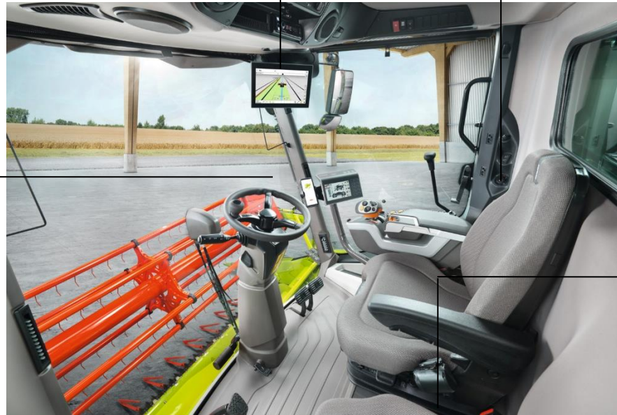
Überkehrkontrolle: Direkte Einsicht durch Sichtfenster in der Kabine
