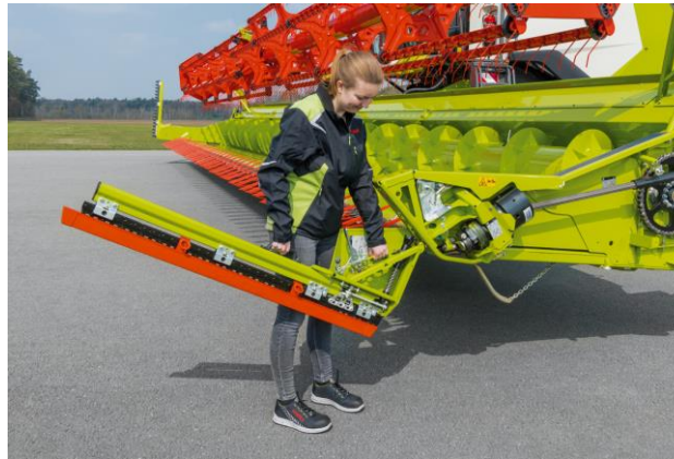
Trennmesser in die untere Aufnahme einhängen.
