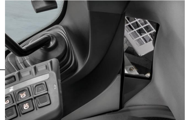
Überkehrkontrolle: Direkte Einsicht durch Sichtfenster in der Kabine
