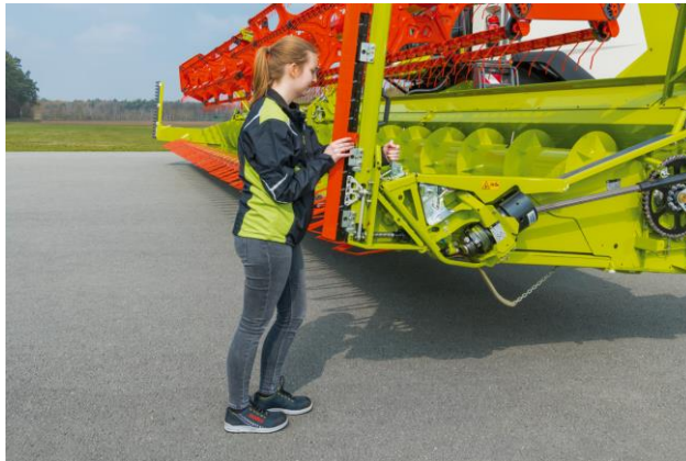
Schnellverschluss einhaken und vorspannen.
