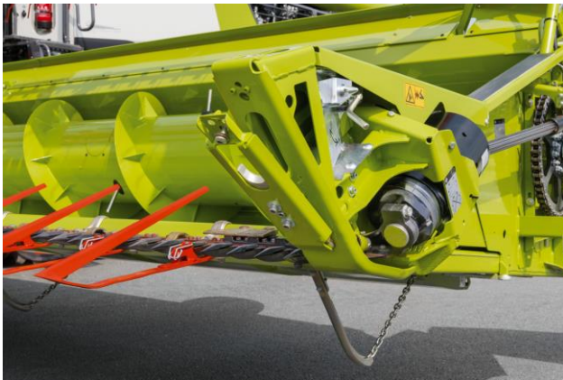
Halmteiler abnehmen und Einstellplatte über Camlock abnehmen.
