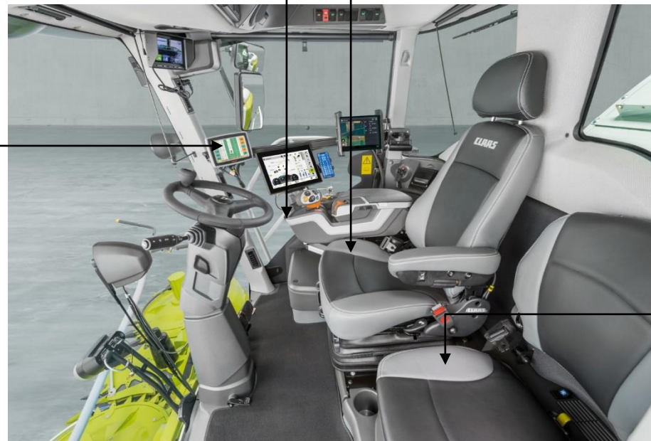
Armlehne mit Fahrhebel und Direktverstellung
