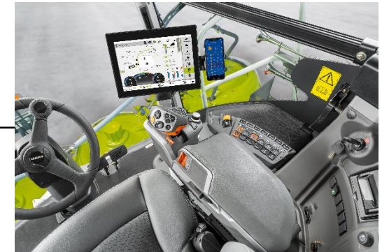
Armlehne mit Fahrhebel und Direktverstellung
