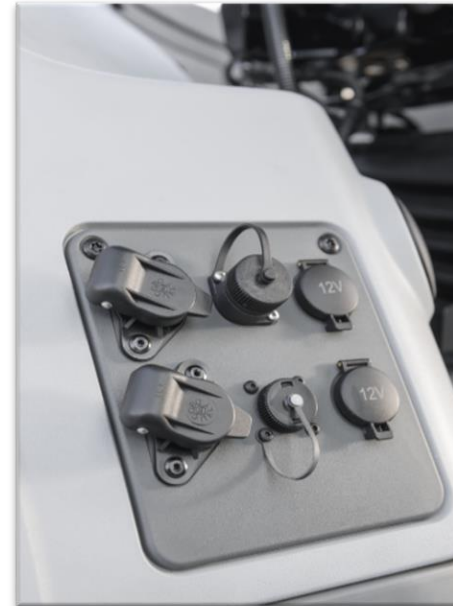
ISOBUS – Schnittstelle in der Kabine
