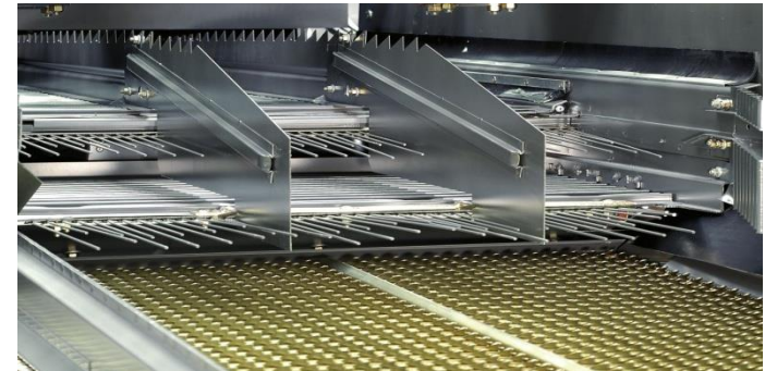
doppelt belüftete Fallstufe
