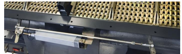
elektrische Siebverstellung (Option)
