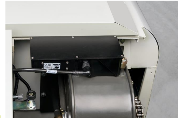
Sensor im Körnerelevator
