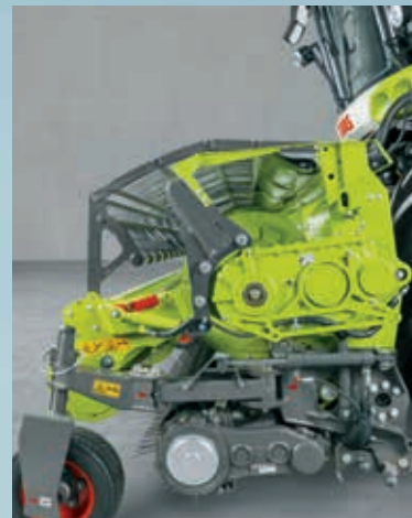
Das Getriebe der PICK UP ist in Öl gelagert.
