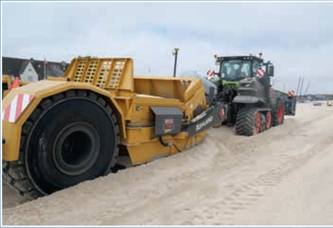
Bei der Sandaufnahme mit dem 12-m 3 -Schürfkübel ist viel Zugkraft gefragt.
