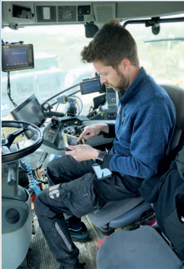
Aufwendige Vorbereitung: Um den Strand wie gewünscht zu formen, muss Broder Christiansen eine externe GPS-Anlage mit dem Gespann verbinden.
