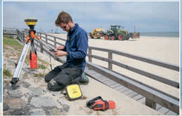
Aufwendige Vorbereitung: Um den Strand wie gewünscht zu formen, muss Broder Christiansen eine externe GPS-Anlage mit dem Gespann verbinden.
