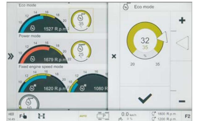
Einstellung der Motordrücke für „Eco“ und „Power“ sowie für den Motordrehzahlspeicher.
