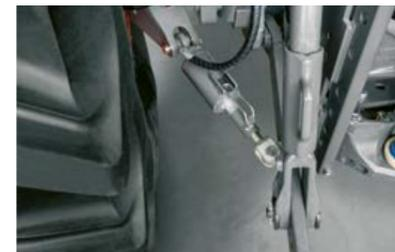
Die optionalen hydraulischen Seitenstabilisatoren sorgen für mehr Sicherheit und erleichtern die Arbeit.
