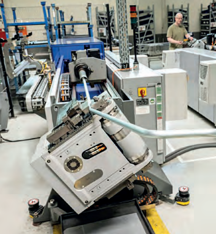
Die Steuerungsdaten für die 3D-Rohrbiegemaschine können direkt aus den Konstruktionsdaten der jeweiligen Landmaschine übernommen werden.
