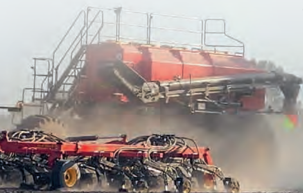
XERION 12.590 TRAC mit einem Seed Hawk 60 Airseeder 18,3 m und PD 680 Air Cart (23.200 l Volumen) in Südost-Australien
