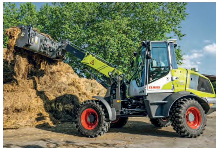
↑ Alle CLAAS Radlader stehen aufgrund des Knickpendelgelenkes sicher auf unebenem Gelände und zeichnen sich durch ein stabileres Kurvenverhalten aus.
