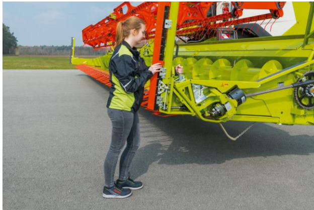
Schnellverschluss einhaken und vorspannen.
