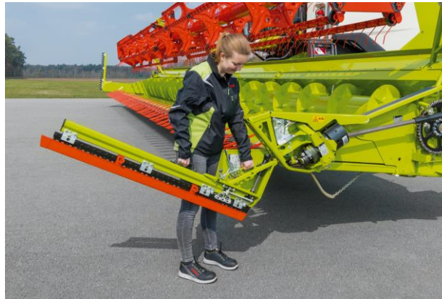
Trennmesser in die untere Aufnahme einhängen.
