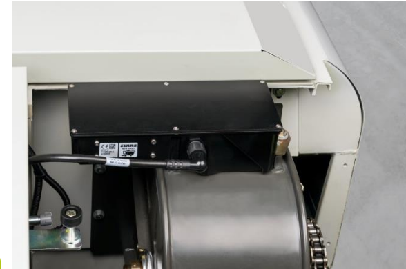
Sensor im Körnerelevator
