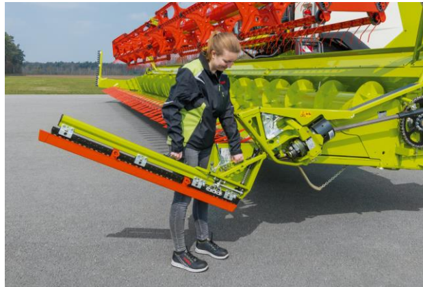
Trennmesser in die untere Aufnahme einhängen.
