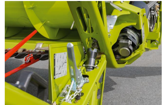
Beim Hochklappen wird der Antrieb gekoppelt.
