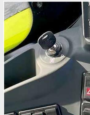
Si l'on tourne la clé en arrière en position « P », la batterie sera bientôt vide.
