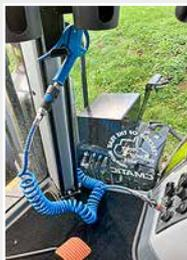
Prise d'air comprimé dans la cabine – super !
